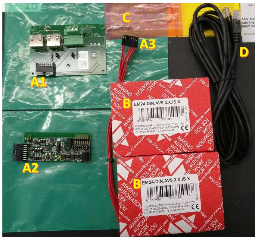
Figura 1 - kit KST485CAN-M e Meter Trifase Carlo Gavazzi EM24-DIN per Ston
